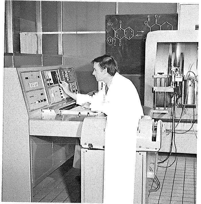
Spectromètre de résonance magnétique nucléaire
